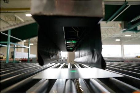
面对不同高度电池的读码难题，Datalogic 得利捷为客户提供了具有液态镜头的 Matrix 300N 产品，有效解决了客户的困难。
